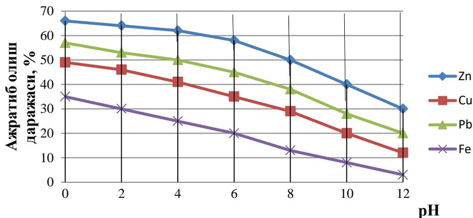
$C_{NaCl}=100\text{г/л}$ ,  $Q:C=1:8$ ,  $t=25^{\circ}\text{C}$ , токнинг анод зичлиги  $0,02\text{ А/см}^2$ , қаршилик кўрсаткичи  $12\text{В}$ ,  $\tau=30\text{ мин}$
