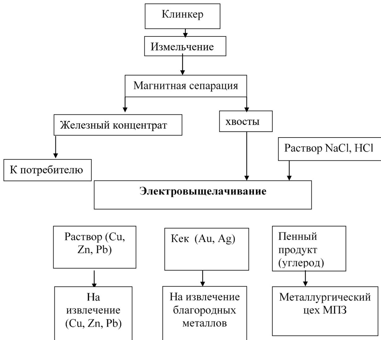
**Рис. 6. Рекомендуемая технологическая схема переработки клинкера**
