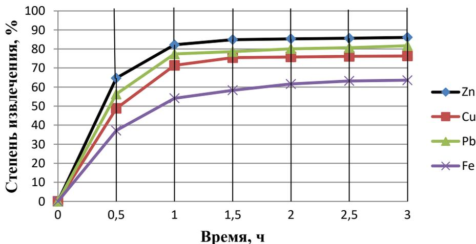
**Рис. 3. Зависимость извлечения металлов в раствор от времени электровыщелачивания**
