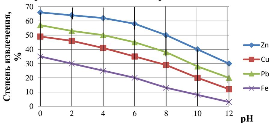
$C_{NaCl}=100$  г/л, Т:Ж=1:8,  $t=25^{\circ}C$ , анодная плотность тока  $0,02$  А/см<sup>2</sup>, величина напряжения – 12 В,  $\tau=30$  мин.
