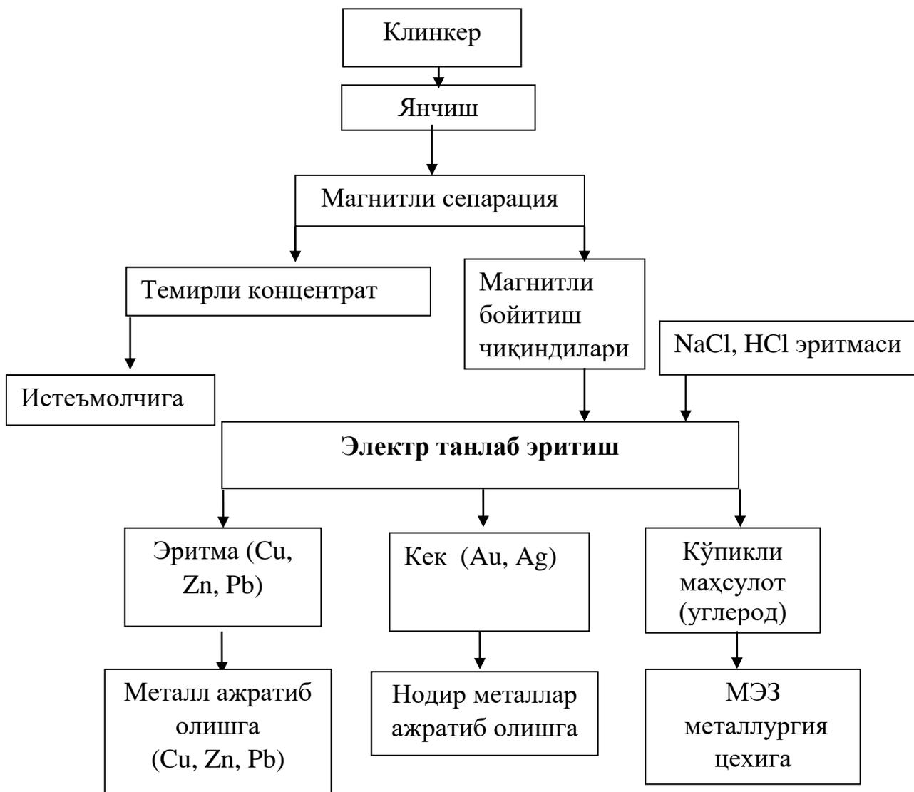
**6-расм. Клинкерни қайта ишлашнинг таклиф қилинаётган технологик схемаси**
