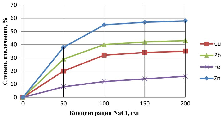
$pH=7$ , Т:Ж=1:8,  $t=25^{\circ}C$ , при анодной плотности тока  $0,02 \text{ A}/\text{cm}^2$ , величина напряжения – 12 В,  $\tau=30$  мин.
