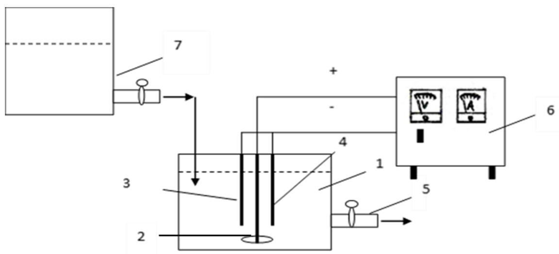
1 – электролизер; 2 – мешалка; 3 – анод графитовый; 4 – катод титановый; 5 – сливной патрубкок; 6 – выпрямитель; 7 – приемник раствора
