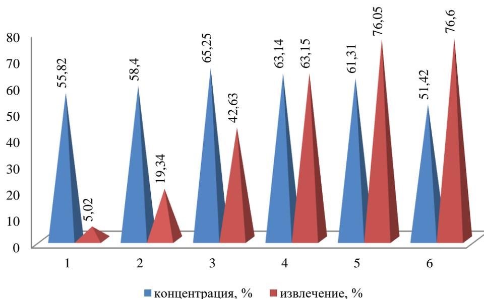
**Рис. 2. Зависимость извлечения железа из состава клинкера методом магнитного обогащения**
