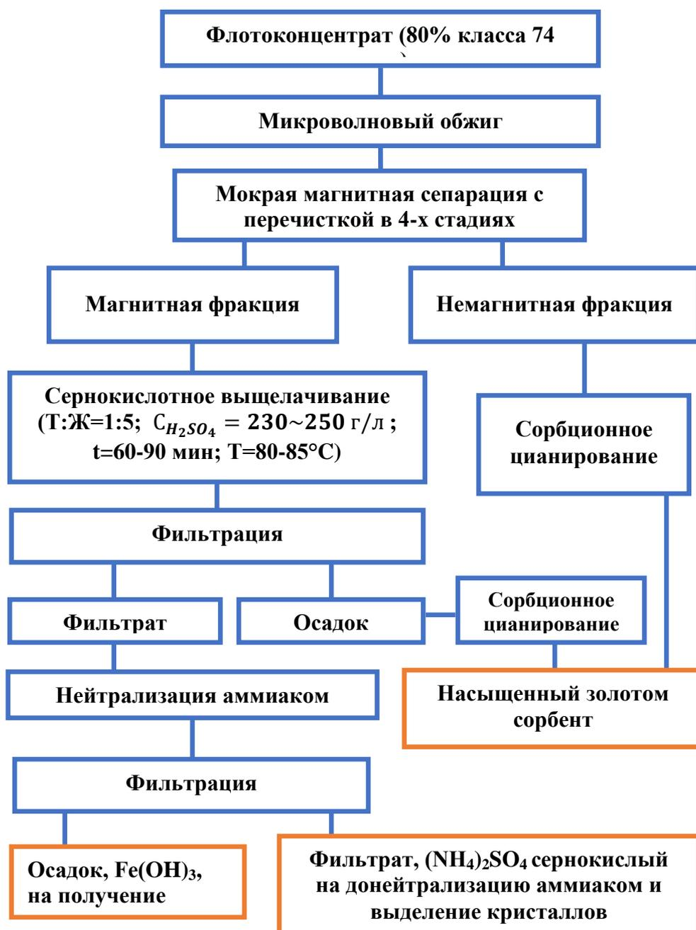
**Рис. 5. Рекомендуемая технологическая схема извлечения золота из упорных золотосодержащих концентратов с попутным получением пигмента на основе железа и неорганического удобрения –  $(\text{NH}_4)_2\text{SO}_4$**
