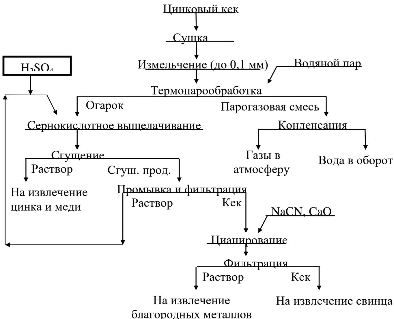
**Рис. 6. Рекомендуемая технологическая схема переработки цинковых кеков**
