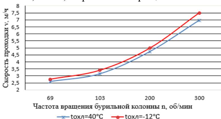
**Рис. 14. График зависимости изменения скорости проходки  $v$  от частоты вращения бурильной колонны  $n$  при осевой нагрузке 10 кН, с различными температурами очистного воздуха  $t_{охл}$**
