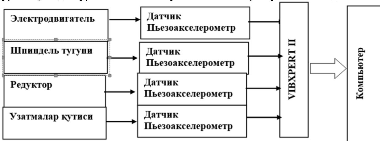
**7-расм. Кон ускуналарининг вибро таҳлили учун аппарат блок схемаси**
