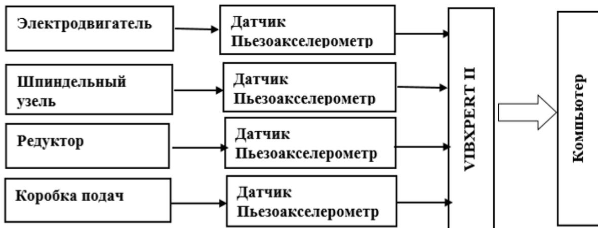
**Рис. 7. Схема аппаратуры для вибромониторинга горного оборудования**
